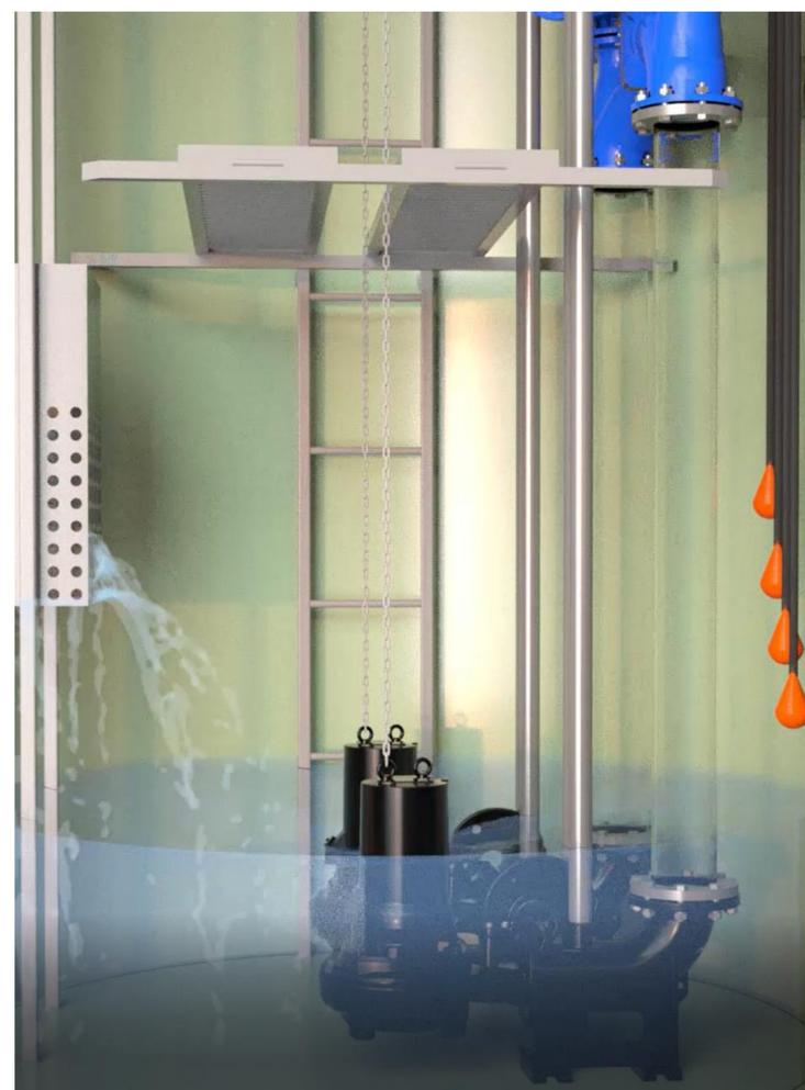
В станции с двумя насосами обычно используются четыре поплавковых выключателя. Один из них расположен на уровне остановки, по одному на уровне пуска каждого насоса, последний используется для срабатывания сигнализации.
