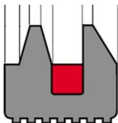
наружной поверхностью трубы и внутренней поверхностью раструба. Двухлепестковые уплотнения изготовлены из мягкой стирол бутадиеновой резины с пластмассовым (полипропилен PP-H) распорным кольцом (Производитель M.O.L.) Именно, благодаря распорному пластиковому кольцу, резиновое уплотнение жестко ограничено со всех сторон, даже незначительные его смещения исключены. Извлечение стопорного кольца при монтаже канализационной системы недопустимо. Материал колец
