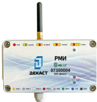
совместим с приборами, оснащенными следующими источниками импульсов: геркон, NAMUR, «открытый коллектор», активный;
