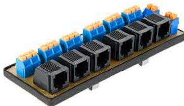
колодок для подключения счетчиков воды с импульсными выходами, 2 двухконтактные нажимные клеммные колодки для подключения сети съема данных RS-485 и питания; индикация напряжения в сети; предусмотрено использование крепежа на din-рейку, стяжки, под шуруп; готовое решение для монтажа; обратите внимание, плата не предусматривает подключения к регистратору импульсов. Для этого используйте специальный переходник.
