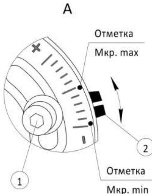
Рисунок 6 – Настройка момента выключения – закрытие.
